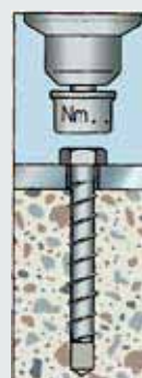
Anker einschrauben und Drehmoment aufbringen
