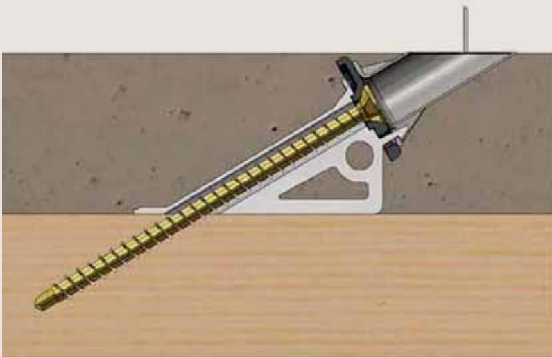
Systemzeichnung des Würth FT-Verbinders mit ASSYplus VG-10mm-Senkopf bei Verlegung von vorgefertigten Betonfertigteilelementen.
